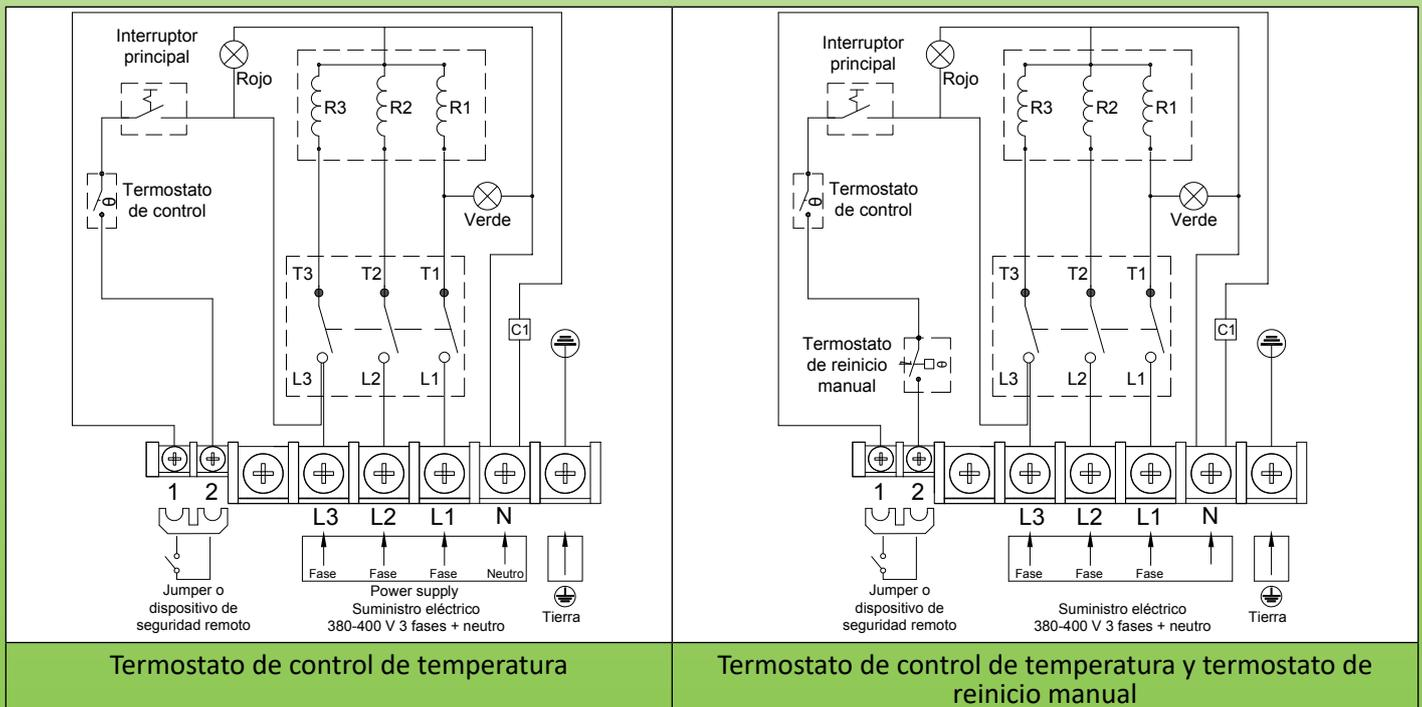
Termostato de control de temperatura
