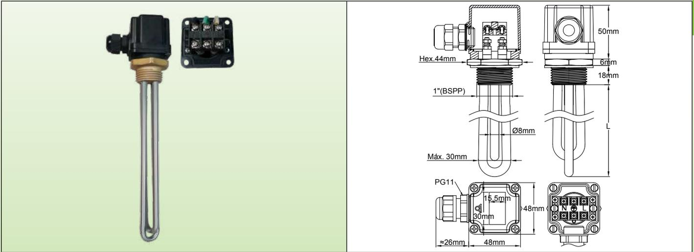
**Principales aplicaciones:** calentamiento de líquidos, circuitos de agua caliente, contenedores y tanques de almacenamiento. Tiene 2 componentes de calefacción de diámetro 8 mm, 230 V, conectados en paralelo. La conexión en serie de estos elementos permite usarlos en 115 V.
