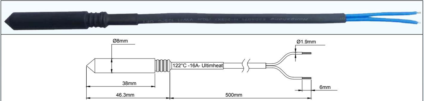
**Aplicaciones:** protección contra el sobrecalentamiento de equipos y componentes de calefacción.
