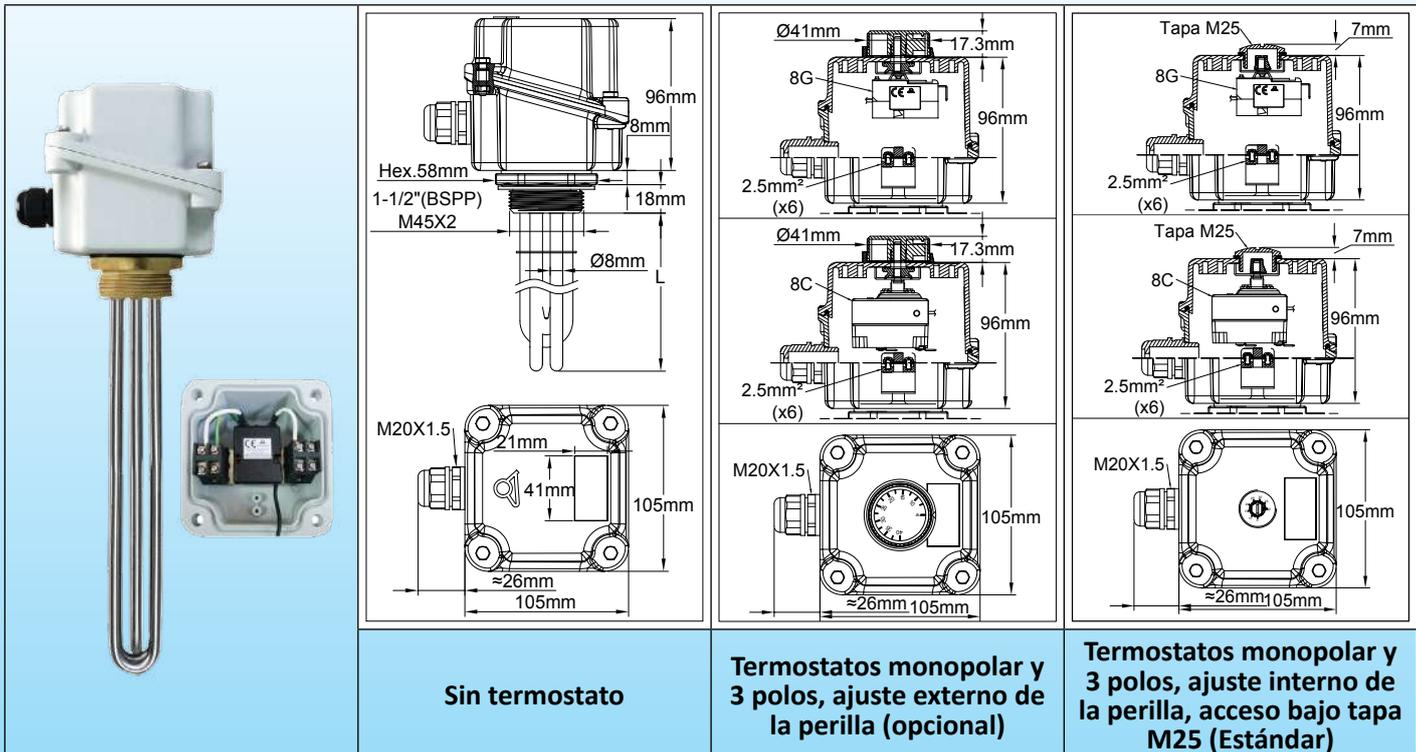
**Principales aplicaciones:** calentamiento de líquidos, circuitos de agua caliente, contenedores y tanques de almacenamiento. Estos calentadores con ese tamaño de caja son los más utilizados porque pueden recibir muchos accesorios como termostatos, limitadores, chivatos, etc., con un tamaño relativamente pequeño.
