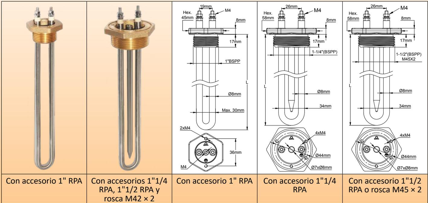
**Principales aplicaciones:** Calentamiento de líquidos, circuitos de agua caliente, contenedores y tanques de almacenamiento. Existen dos tipos estándar de densidad de carga superficial: 5 W/cm<sup>2</sup> y 10 W/cm<sup>2</sup> (Otros disponibles previa solicitud). Consulte la introducción técnica para seleccionar la mejor carga superficial.
