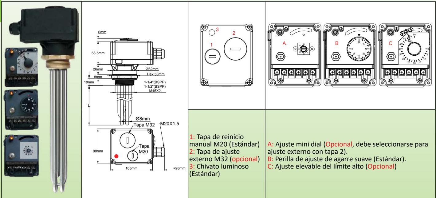
**Principales aplicaciones:** calentamiento de líquidos, circuitos de agua caliente, contenedores y tanques de almacenamiento. Estos calentadores están diseñados específicamente para tanques de agua caliente domésticos y comerciales, así como para sistemas de calefacción auxiliar de tanques de almacenamiento de energía solar y calentadores auxiliares para bombas de calor.
