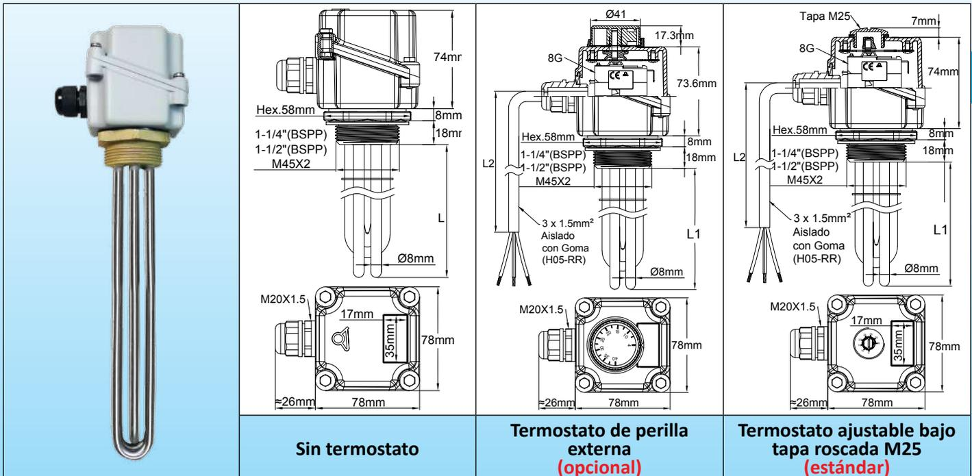
**Principales aplicaciones:** calentamiento de líquidos, circuitos de agua caliente, contenedores y tanques de almacenamiento. **Estos calentadores son los de menor tamaño con carcasa de aluminio que pueden recibir un termostato ajustable. Pero no hay suficiente espacio en el interior para agregar un bloque de conexión. Por lo tanto, los modelos con termostatos se suministran con un cable aislado de goma de 2 metros de longitud, 3 × 1,5 mm<sup>2</sup>.**
